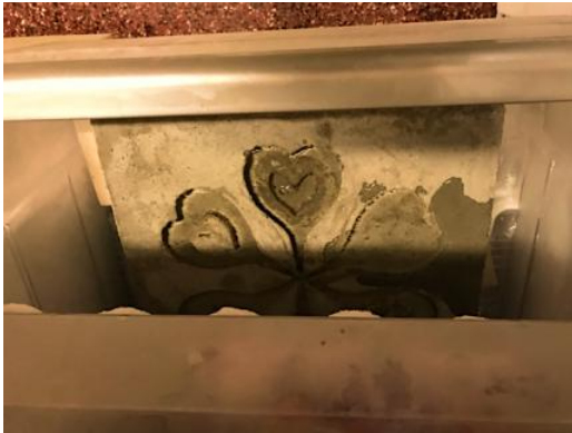
Figuur 3 (proef)Tegel, reliëf gevuld met water in de vriezer.
