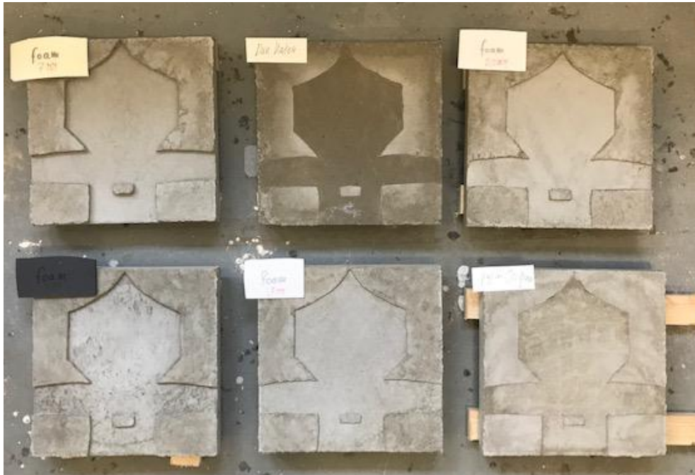
Figuur 6 Atelierproeven: effect van verschillende soorten en dikte inleg materialen in de mal bij het storten van betontegels. Weinig effect van de diepte van het reliëf!
