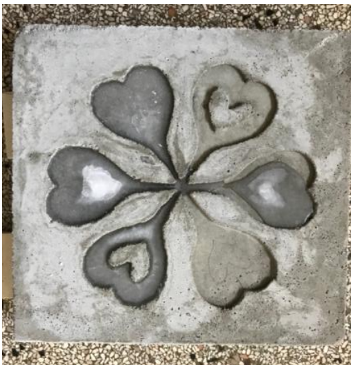
Figuur 4 (proef)Tegel na ontdooien: de randen zijn niet aangetast.
